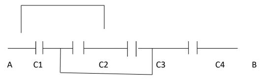
Given C1=  $5\mu F$ ; C2=  $10\mu F$ ; C3=  $15\mu F$ ; C4=30Mf
